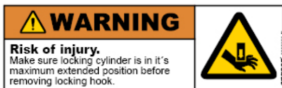
Afbeelding45. Waarschuingssticker op vergrendelcilinder.
